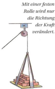
Auch mit Rollen kannst du deine Muskelkraft verstärken. Bei einer **festen Rolle** ist die Zugkraft genauso groß wie die Gewichtskraft der Last. Trotzdem fällt es dir leichter, eine schwere Last zu heben, weil die Richtung der Kraft geändert wird. Dabei ist es egal, ob du senkrecht oder schräg am Seil ziehst.
